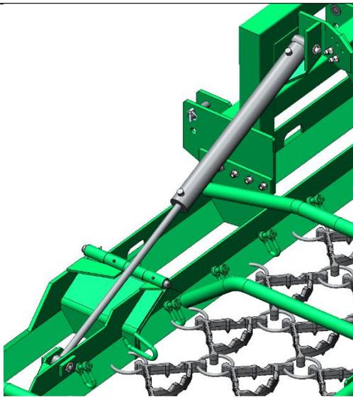
Hydraulikzylinder mit Bolzen und Scheiben montieren und mittels Spannstift sichern.
