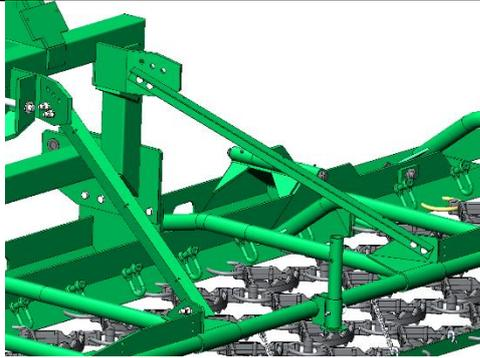
Streben vom Turm zum hinteren Rahmen montieren. Hierfür Schrauben M16x55 verwenden.
