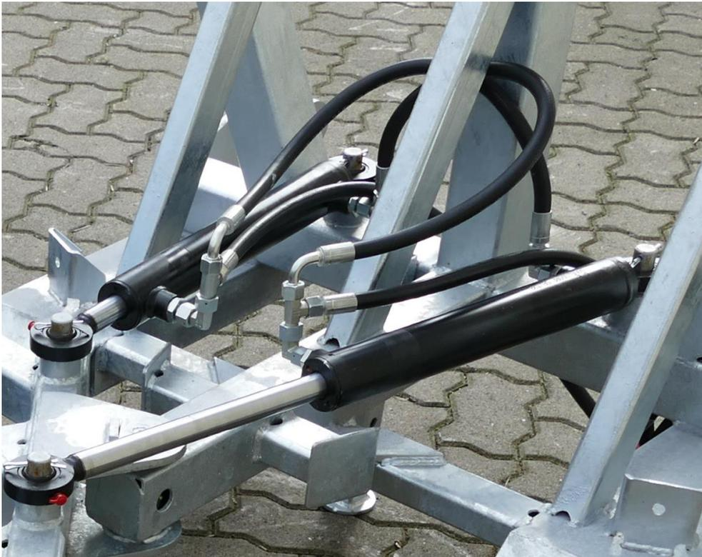
Bild 1: Anschluss der Hydraulikschläuche beim Gummischieber 70°
