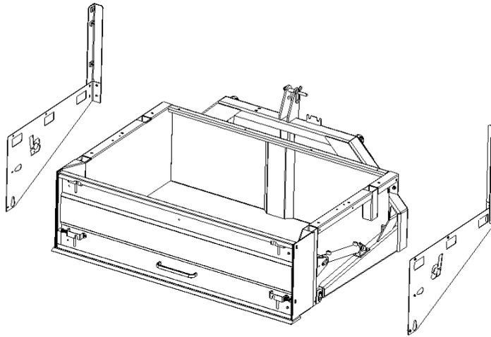
2. Aushängen der Heckklappe und demontieren der oberen Verriegelung der Heckklappe.
