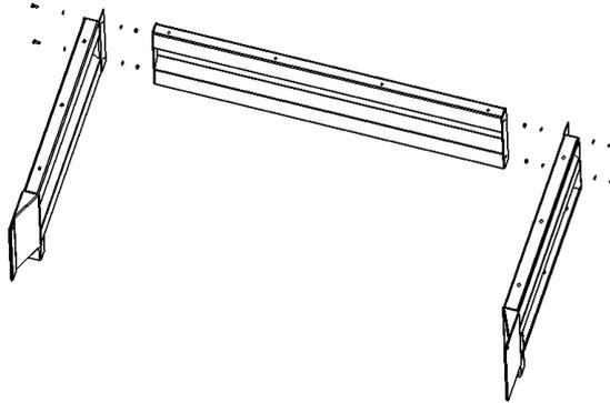
2. Erhöhung aufsetzen und mit Schrauben M10x25, Unterlegscheiben und Sicherungsmuttern an Heckcontainer HD anschrauben.
