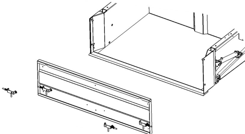
3. Anbauen der Schwenkarme mit Schrauben M10x30, Unterlegscheiben und Sicherungsmutter.
