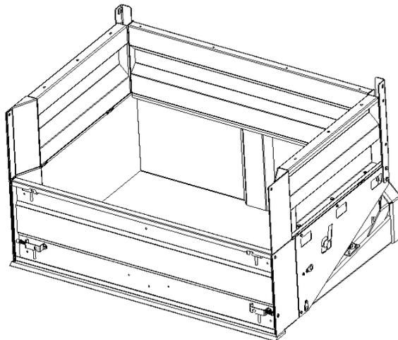
3. Verbindungstreben an untere Heckklappe mit Sterngriffen und Unterlegscheiben montieren.
