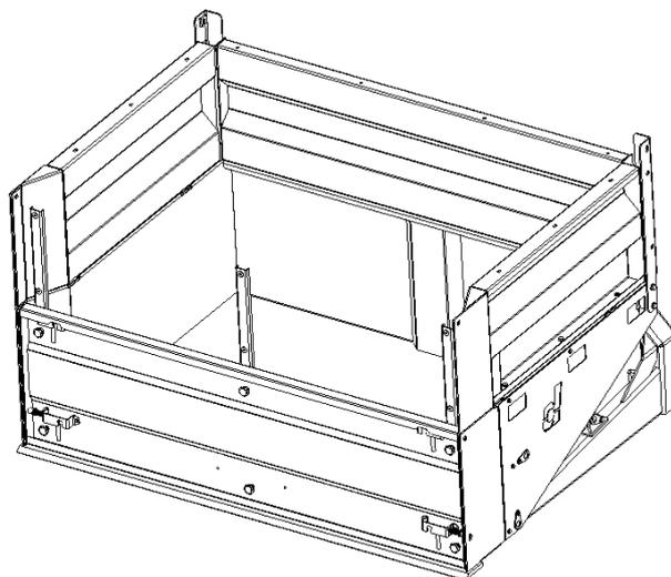
4. Obere Heckklappe einhängen und an Verbindungsstrebe mit Sterngriffen und Unterlegscheiben anschrauben.
