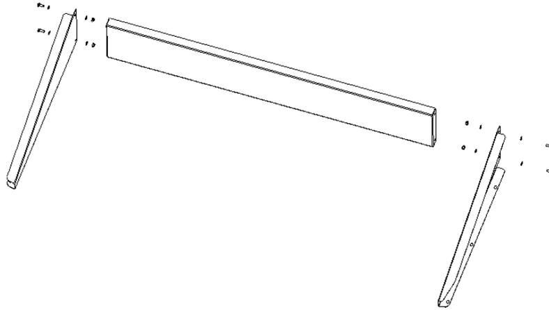
2. Aufsetzen der Erhöhung auf Heckcontainer HD und mit Schrauben M10x25, Unterlegscheiben und Sicherungsmuttern an Heckcontainer HD anschrauben.
