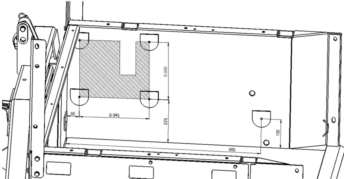
In der Stirnwand können die Zurrösen beidseitig entlang der eingezeichneten Linien montiert werden.
