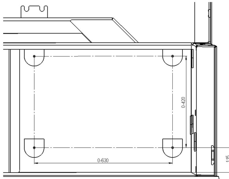
Die Montage der Zurrösen erfolgt mit Schrauben M8x25, Unterlegscheiben, Sicherungsmuttern und Verstärkungsplatten.
