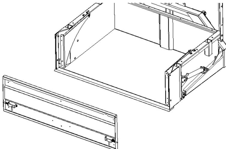
4. Heckklappe an Schwenkarme mit Schrauben M8x20, Unterlegscheiben und Sicherungsmutter montieren. Hierzu auch die äußeren Schrauben der unteren Verriegelung lösen.
