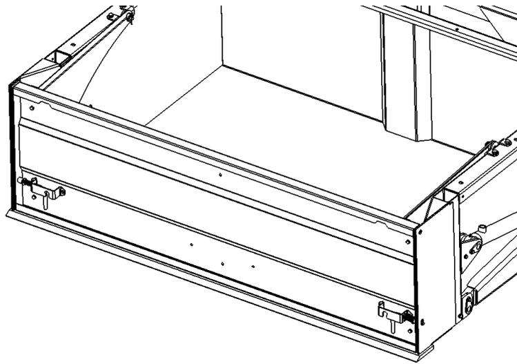
5. Bügelgriff mit M8x16 am Heckklappe anschrauben.
