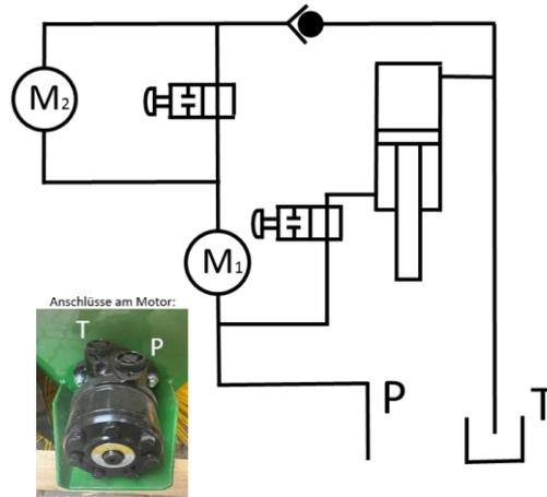
Anschlussplan der Hydraulikkomponenten
