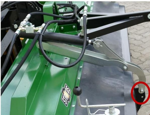
Anordnung der Hydraulikkomponenten
