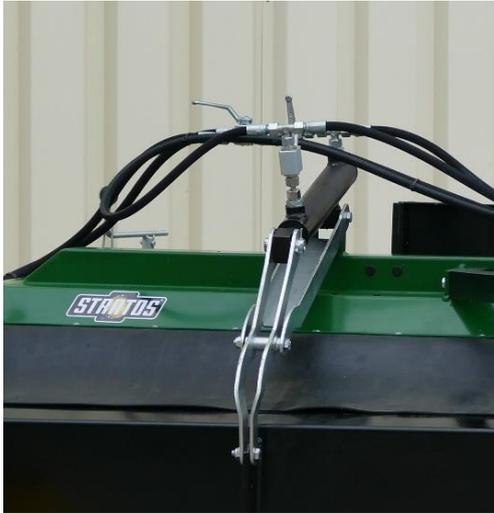
Montage des Zylinders mit Hebel
