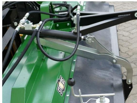
Anordnung der Hydraulikkomponenten
