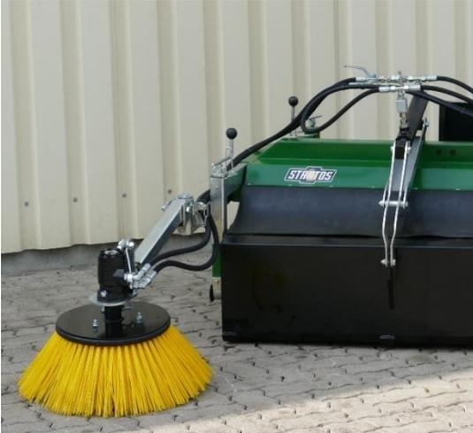
Montage der hydraulischen Sammelwanne mit Seitenkehrbesens
