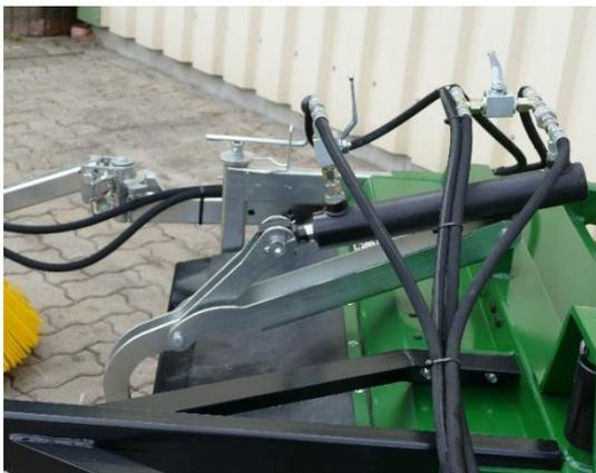
Anordnung der Hydraulikkomponenten
