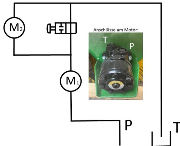
Anschlussplan der Hydraulikkomponenten
