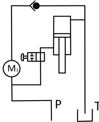
Anschlussplan der Hydraulikkomponenten
