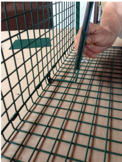
Auslöser in die Falle einsetzen
