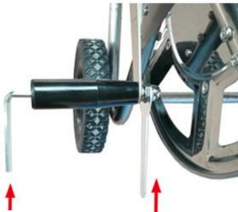
Stecken Sie die Handkurbel auf die Halterung und drehen dann die Scheibe / Mutter auf das Gewinde. Befestigen Sie die Schraube mit einem Sechskantschlüssel und einem Maulschlüssel.
