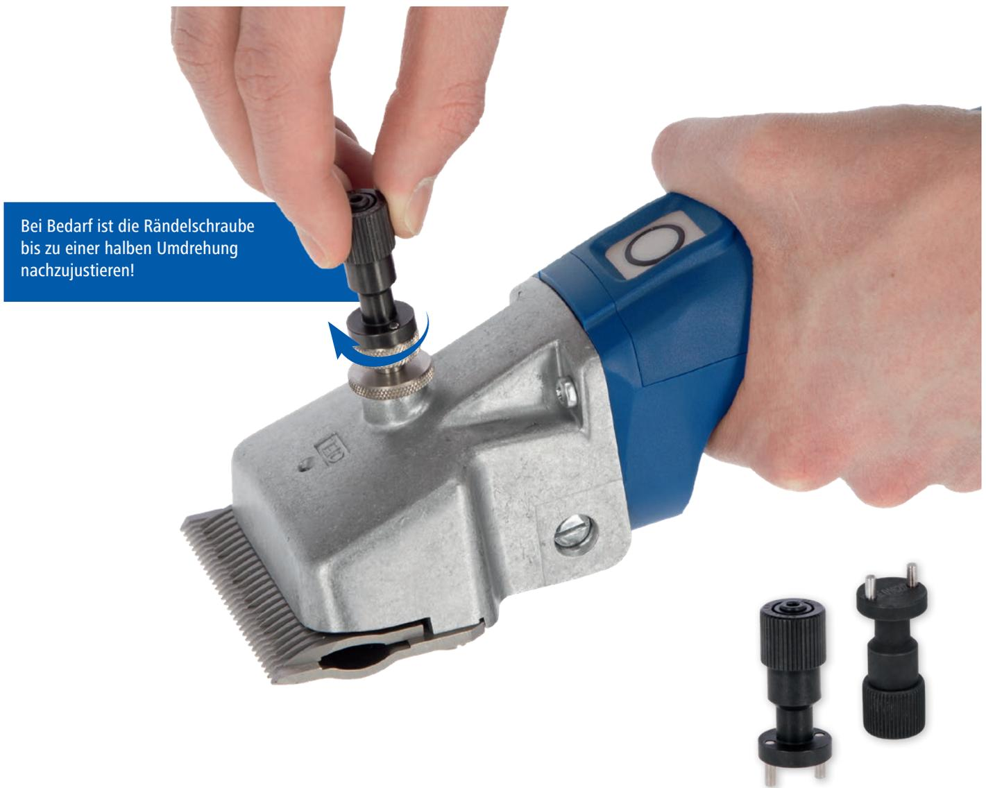
Bei Bedarf ist die Rändelschraube bis zu einer halben Umdrehung nachzujustieren!
