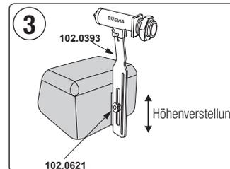
**DE** Umbausatz Schwimmerventil MASTERFLOW mit Ventilabdeckung
