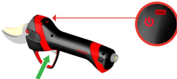
4. Um den Sicherheitsbereich zu wählen, drücken Sie bei gedrückt gehaltenem Auslöser die Taste „Einstellungen“. Bei jedem Drücken wechselt der Sicherheitsbereich und die LEDs des Bargraphen ändern sich entsprechend der Auswahl:
