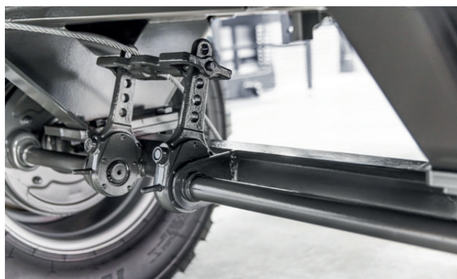
Die ADR-Achsen werden je nach Fahrzeugtyp verbaut: Die 70/70-Achse hat eine Achslast von 5,4 t, die 90/90-Achse von 9,2 t. Beide Achsen verfügen über einen manuellen Gestängesteller und haben eine Spurweite von 1,55 m.
