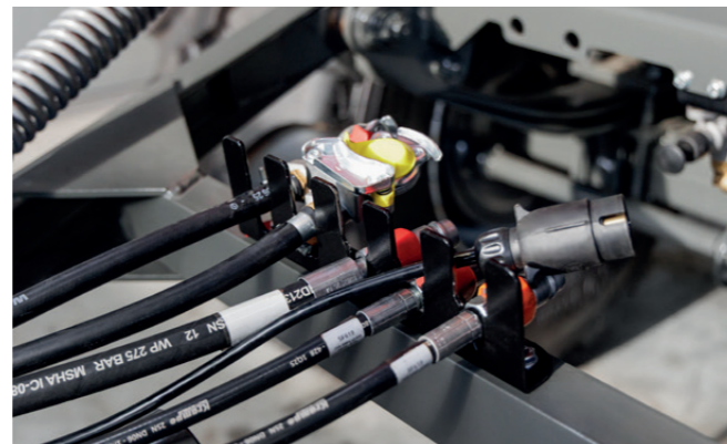
Der Schlauchgalgen sorgt für eine ordentliche Ablage von Schläuchen und Kabeln nach dem Anhängen – nichts stört, alles ist griffbereit.
