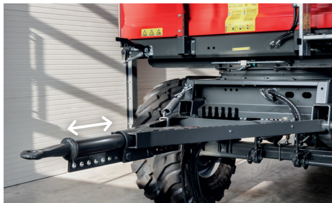
Zur Auswahl stehen eine starre Deichsel (2100 mm) und eine verstellbare Y-Deichsel. Letztere lässt sich flexibel von 1700 bis 2300 mm einstellen.
