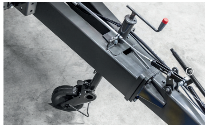
Das höhenverstellbare Stützrad aus Metall erleichtert das An- und Abkuppeln des Anhängers. Zudem ermöglicht es das Rangieren des Wagens von Hand.
