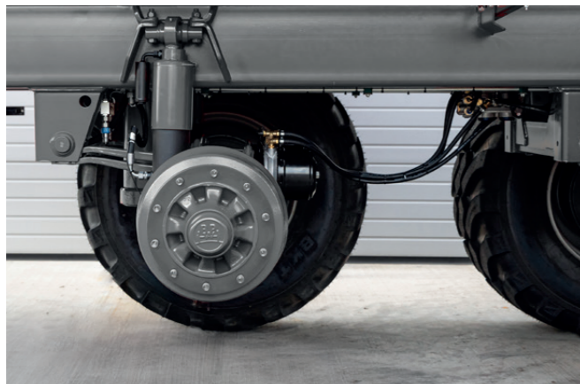
Hydraulische Fahrwerke von Krampe sind serienmäßig mit Schutzrohren ausgestattet – für optimalen Schutz der doppelt verchromten Kolbenstangen vor Steinschlag.
