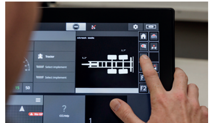
Die elektronische Zwangslenkung wird mittels ISOBUS-Steuerung über das Terminal der Zugmaschine bedient. Darüber hinaus ist optional eine vollumfängliche Fahrzeugsteuerung über ISOBUS verfügbar.
