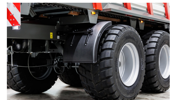
Die stabilen Viertelschalen-Kotflügel vorne und hinten halten das Fahrgestell sauber.
