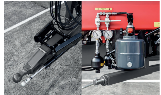
BPW Zwangslenkung: dw-Geberzylinder befindet sich vorne an der Zugvorrichtung, Fahrtrichtung links & rechts beim Tridem, hydr. Anlage komplett mit Handpumpe, Manometern und Stickstoffspeichern.
