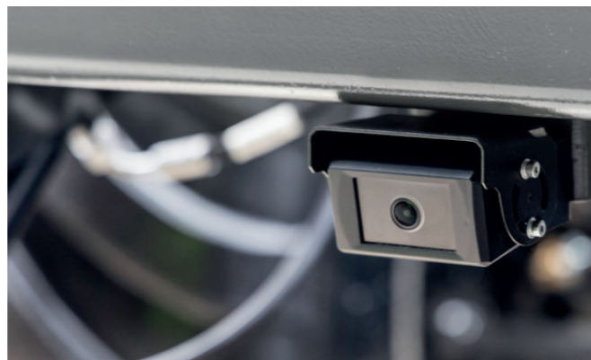
Wahlweise mit Standard- oder KI-Rückfahrkamera mit Personen-erkennung – beide in robuster Ausführung für den landwirtschaftlichen Einsatz.
