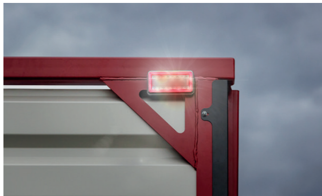
Die oben liegenden LED-Rückleuchten erhöhen die Sicherheit im Straßenverkehr, da sie besser sichtbar sind.
