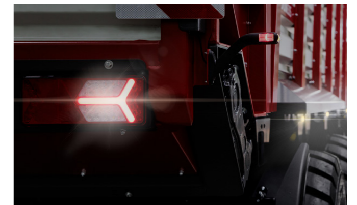
Die Heckklappe ist mit 5-Kammer-LED-Rückleuchten ausgestattet, zusätzlich sorgen Seitenmarkierungsleuchten für eine gute Sichtbarkeit im Straßenverkehr.
