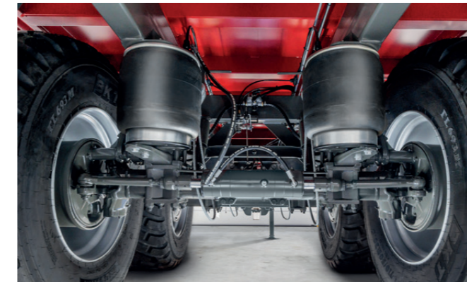
BPW Nachlaufenkung: Ausführung mit Wellendruckscheibe für ein ruhiges Fahrverhalten. Die Lenkachse muss bei Straßenfahrten hydraulisch gesperrt werden.
