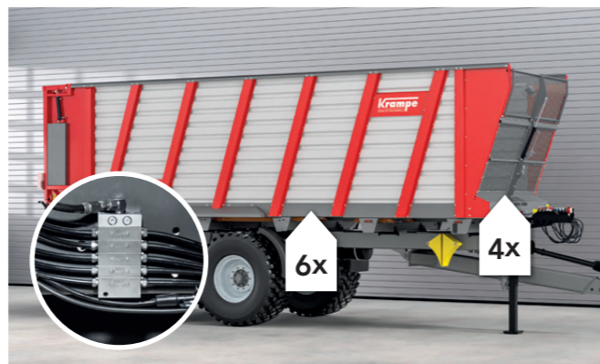
Ein zentraler Schmierpunkt ermöglicht das Abschmieren von vier Lagern der Kratzbodenumlenkung sowie sechs Lagern des Zapfwellendurchtriebs. Eine praktische Option für eine einfache und effiziente Wartung.
