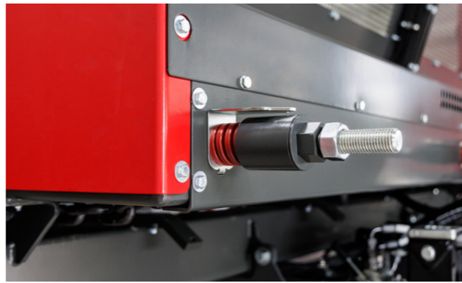
Jede Kratzbodenkette wird einzeln gespannt: Eine Mutter übernimmt das Spannen, die zweite dient als Sicherung. Eine Lehre am Chassis zeigt an, ob die Spannung korrekt ist.
