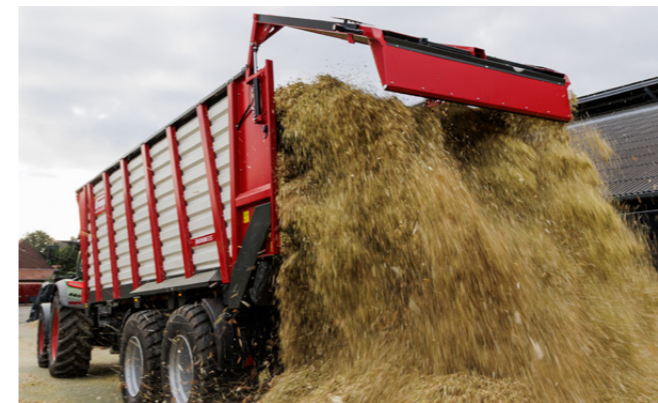
Der RADIUM hat einen konischen Aufbau: Die Rückseite ist 5 cm breiter als die Vorderseite, was eine optimale Entladung unabhängig vom Silageprodukt gewährleistet.
