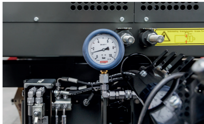
Das Balgdruckmanometer liefert einen Anhaltswert zur Beladung des Wagens und ist bei Fahrzeugen mit Luftfahrwerk einsetzbar.
