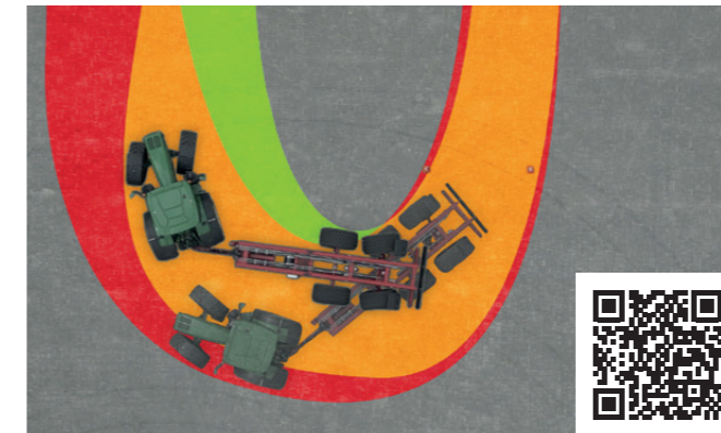
Unsere elektronische, geberlose Zwangslenkung ermöglicht es dem Anhänger aktiv mit zu lenken. Dies sorgt für eine erheblich verbesserte Spurführung und Wendigkeit des Fahrzeugs.
