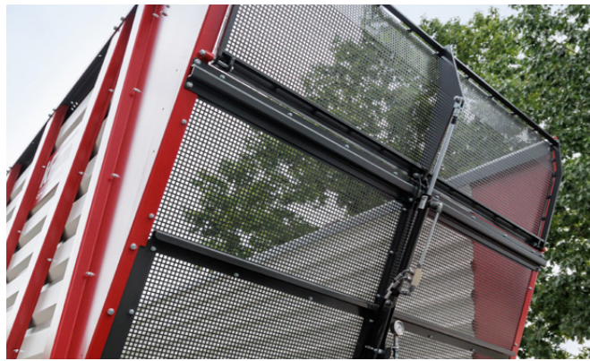
Die Gitterstirnwand gewährt freie Sicht in den Ladeinnenraum. Die serienmäßig verbaute hydraulische Anhängselklappe erleichtert das Beladen über den Traktor.
