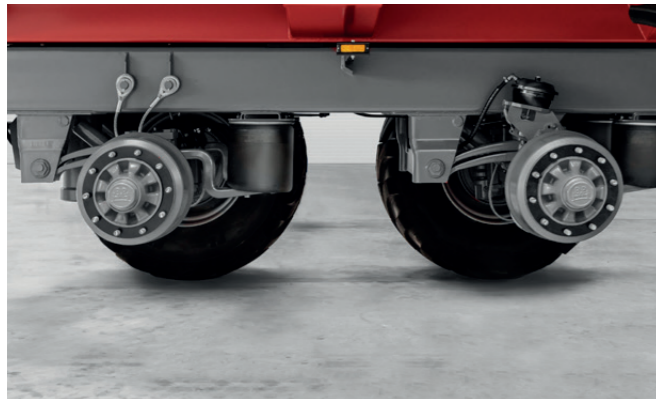
Luftgefederte Fahrwerke sind im Trend und werden auf Wunsch verbaut. Die großen Luftfederbälge sorgen für Laufruhe und ein stabiles Fahrverhalten.
