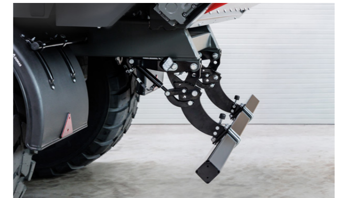
Der hydraulisch klappbare Unterfahrerschutz kann bequem aus der Traktorkabine angesteuert werden.
