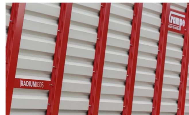
Ganzstahl-Profilbleche machen die Seitenwand besonders robust. Schlanke Rungen setzen dynamische Akzente und unterstützen die Stabilität des Aufbaus.
