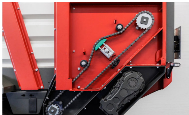
Der Kettenantrieb der Dosierwalzen ist sicher hinter einer Abdeckung geschützt, die bei Bedarf einfach geöffnet werden kann. Durch den automatischen Kettenspanner bleibt die Kette wartungsarm auf optimaler Spannung.
