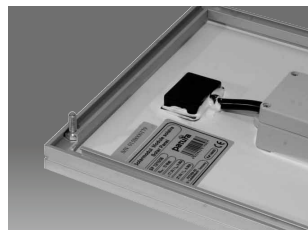
Schieben Sie je zwei Schrauben (M6x16) oben und unten in das Aluprofil des Solarmodulrahmens.
