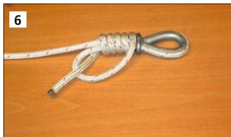
Nach fünf Windungen führen Sie das Ende durch die Schlaufe heraus.
