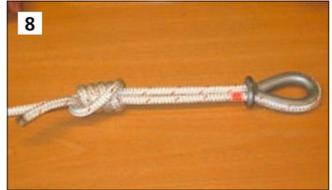
Drehen Sie die Windungen des Knoten zusammen. Durch Ziehen am losen Ende festigen Sie den Knoten zusätzlich.
