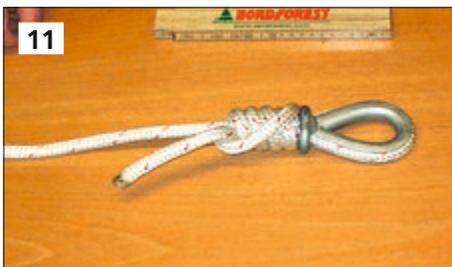
Der fertige Knoten. Bitte das Seil nur im geraden Zug einsetzen.
