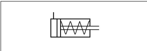
Bei richtig eingestellter Bremse beträgt der Kolbenhub etwa ein Drittel des angegebenen maximalen Hubes (Nachstellung spätestens bei zwei Dritteln des maximalen Hubes erforderlich). Die Rohrleitungen sind so anzupassen, daß sie nach dem Anziehen der Überwurfmutter spannungsfrei sind. Andernfalls kann es zu Beschädigungen der Zylinder, z.B. zum Einreißen der Zylinderböden, kommen.
