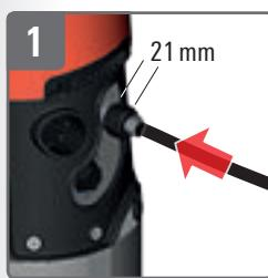
Schlauch an Anschluss schrauben
