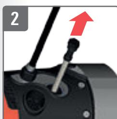
Filter entfernen und reinigen
