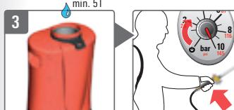
Sauberes Wasser nachfüllen, Gerät einschalten (10 bar), sprühen bis keine Flüssigkeit mehr austritt
