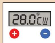
10-Grad-Schritten verändern. Durch langes Drücken der Plus- oder Minustaste beginnt die Anzeige automatisch anzulaufen. Stellen Sie nun den gewünschten Sollwert ein, z.B. 28,0 °C. Die rote LED blinkt, wenn die Solltemperatur um mehr als 1 °C über- oder unterschritten wird. Im Beispielsfall bei unter 27,0 °C und über 29,0 °C.
