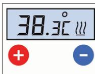
Stellen Sie nun den gewünschten Sollwert ein, z.B. 38,3 °C. Die rote LED blinkt, wenn die Solltemperatur um mehr als 1 °C über- oder unterschritten wird. Im Beispielfall bei unter 37,3 °C und über 39,3 °C.
