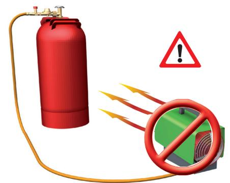
Um ein Vereisen der Gasflasche(n) zu vermeiden, ist die Gasversorgung entsprechend dem Anschlusswert des Gerätes, der Betriebsdauer und der Umgebungstemperatur der Versorgungsbehälter auszulegen.
