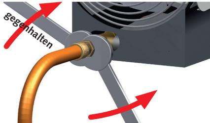
**Gasschlauch lösen:** Überwurfmutter **im Uhrzeigersinn** drehen
