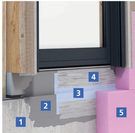
Formel-Pro Reaktivabdichtungen eignen sich ideal, um bodentiefe Fenster- und Türelemente an die übrige Bauwerksabdichtung anzuschließen. So werden Materialwechsel zwischen Kunststoff, Bauschaum, Metall und Dämmung sicher überbrückt.
