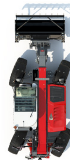
HUNDEGANG-LENKMODUS – für effizientes Befüllen und Planieren und für Arbeiten an Mauern und in engen Räumen.
