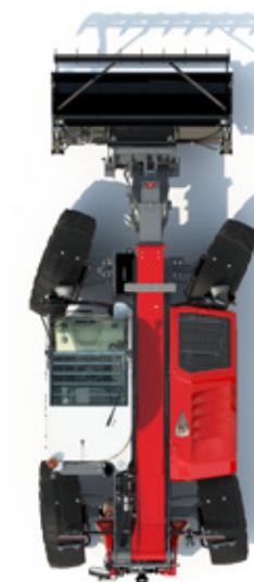
SEMI-HUNDEGANG-LENKMODUS mit definiertem Hinterrad-Winkel - nützlich für Anwendungen wie Silagearbeiten und Stallreinigung.
