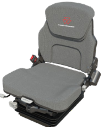
LUFTFEDERUNG Längsfederung, Heizung. Erhältlich für alle Modelle.*
