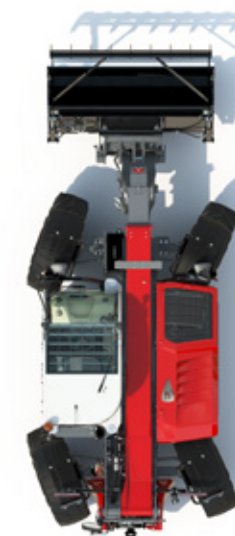
ALLRAD-Lenkung – für minimale Wendekreise. Egal ob bei dem exakten Fahren in engen Gebäuden oder beim schnellen Verladen Ihrer Erntegüter.
