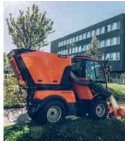
Kehmaschinen Aufbau SX2 für Rasco MUVO
