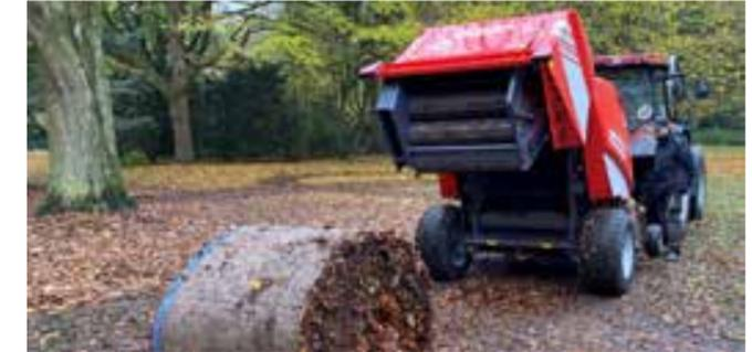
Das Laub wird durch die Pickup sauber aufgenommen und durch einen Rotor der Kammer zugeführt und gepresst. Pro Ballen werden bis zu 400 kg Laub gepresst, das alles mit einem sehr kompakten Ballenmaß von 110 cm Durchmesser und einer Breite von 100 cm. Der Abtransport zur Entsorgung und die gesamte Logistik wird deutlich einfacher, spart Zeit und reduziert die Kosten.
