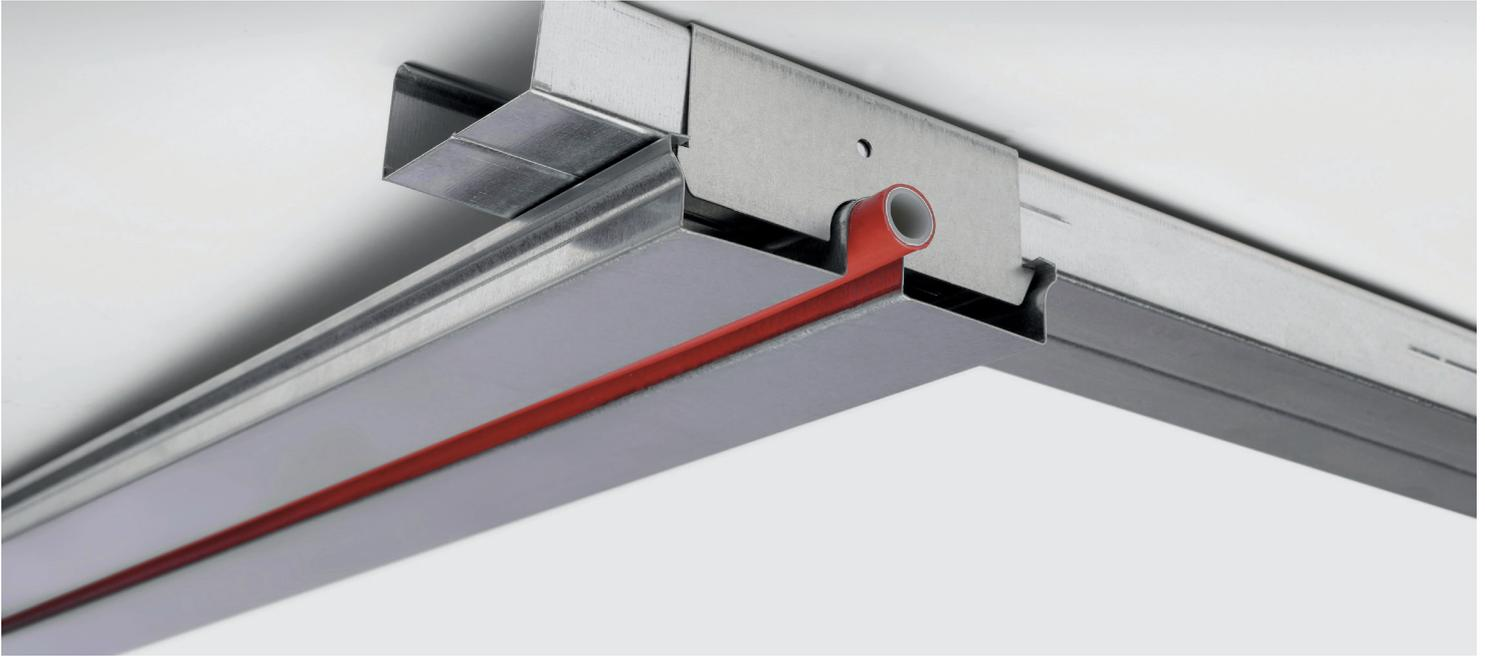
Das Klimaprofil kann direkt an die Decke oder an Dachbalken montiert werden. Damit ist bereits alles für die Installation vorbereitet: Die Rohrleitung des Heizkreises wird einfach in die Nut der Profile eingedrückt und an das vorhandene Heizsystem angeschlossen. Anschließend können Gipskarton oder Gipsfaserplatten auf die Profile montiert werden. Nach dem Verspachteln, Streichen oder Verputzen ist dieser Aufbau einsatzbereit und kann bereits mit 30mm Gesamthöhe umgesetzt werden.
