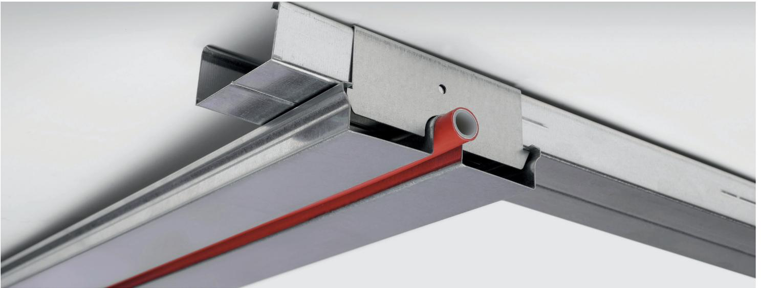
Das Klimaprofil kann direkt an die Decke oder an Dachbalken montiert werden. Damit ist bereits alles für die Installation vorbereitet: Die Rohrleitung des Heizkreises wird einfach in die Nut der Profile eingedrückt und an das vorhandene Heizsystem angeschlossen. Anschließend können Gipskarton oder Gipsfaserplatten auf die Profile montiert werden. Nach dem Verspachteln, Streichen oder Verputzen ist dieser Aufbau einsatzbereit und kann bereits mit 30mm Gesamthöhe umgesetzt werden.
