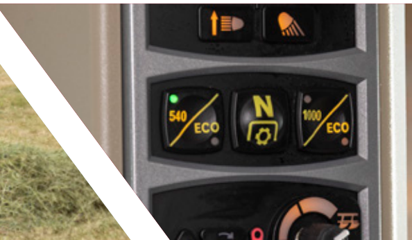
Elektrohydraulisch vorgewählte Zapfwellendrehzahl
