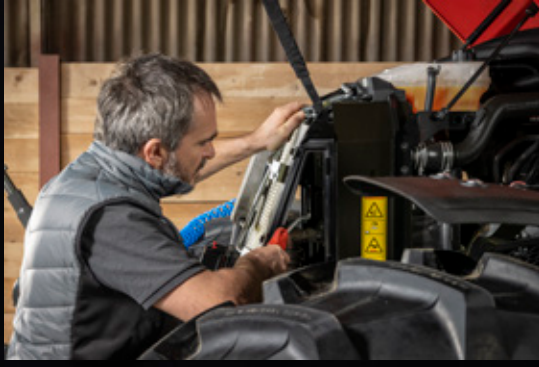
Die Kühlereinheit ist leicht zu erreichen und lässt sich dadurch bequemer und schneller reinigen.
