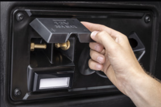
Beim optionalen Profi-Paket ist ein 12-Volt Anschluss in den Kraftstofftank integriert, um eine externe Kraftstoff- oder AdBlue®-Pumpe zu betreiben.
