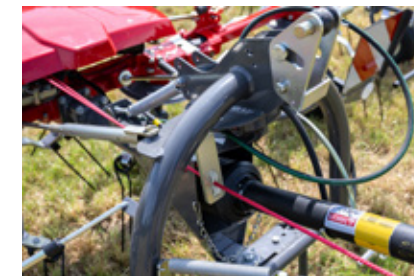
▲ Automatische Werkzeugverriegelung am Dreipunkt-Anbaubock
