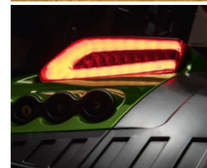
Neue LED-Rückleuchten (CAN-fähig) mit dynamisch wischendem Blinker
