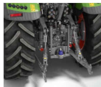
Heckkraftheber mit Schnellfanghaken und Seitenabstützung (EU)
