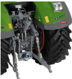
Heckkraftheber mit Schnellfanghaken und Seitenabstützung (EU)
