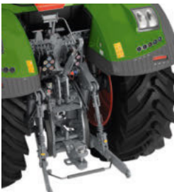
Heckkraftheber mit Kugelen und Rub Blocks
