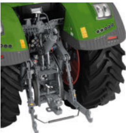
Heckkraftheber mit Schnellfanghaken und Rub Blocks (AU)
