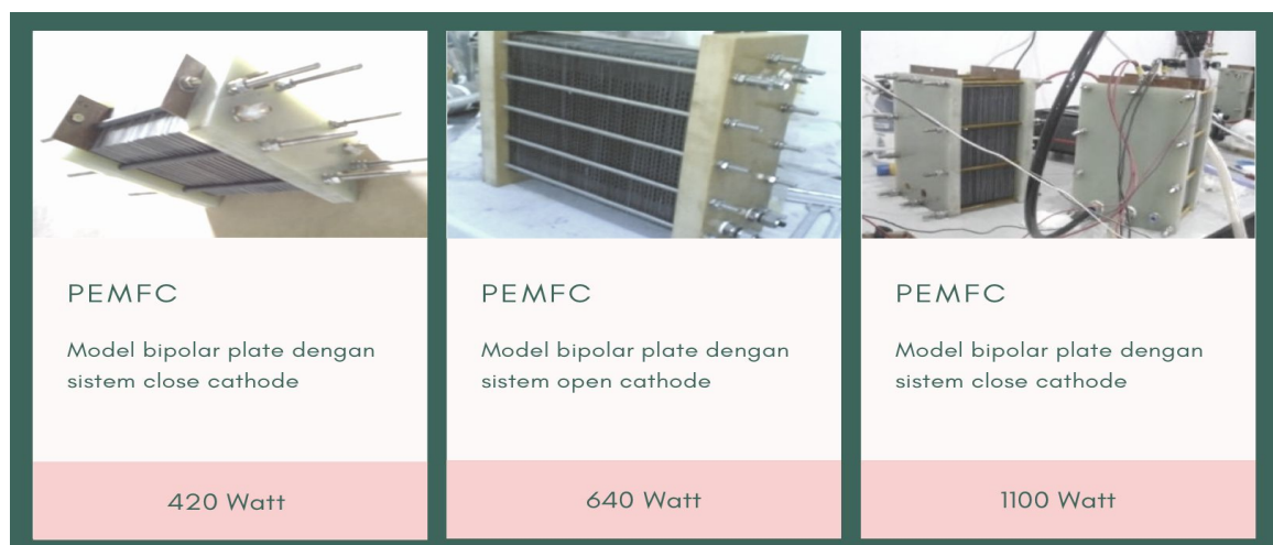
Gambar 10. Prototipe PEMFC produk lokal (Sumber: IFHE).
