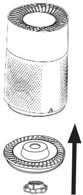
5. Setzen Sie den Gehäuseboden wieder ein und drehen Sie den großen Drehverschluss an der Unterseite fest zu.
