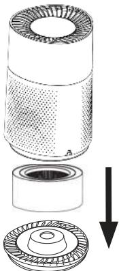
3. Теперь фильтр и дно прибора можно снять в направлении вниз.
