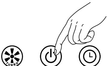
6. Appuyez sur la touche ON/OFF du filtre à air sous tension et maintenez-la enfoncée pendant 20 secondes jusqu'à ce que le voyant rouge du filtre s'éteigne.
