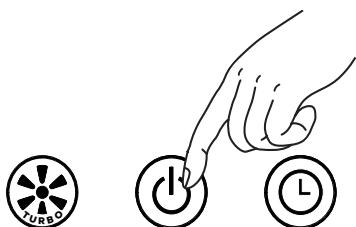
6. Naciągnąć i przytrzymać wciśnięty przycisk WŁ./WYŁ. na włączonym oczyszczaczu powietrza przez 20 sekund, aż zgaśnie czerwony wskaźnik FILTR.
