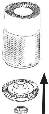
5. Remettez en place le fond du boîtier et vissez fermement le grand bouchon sur la face inférieure.
