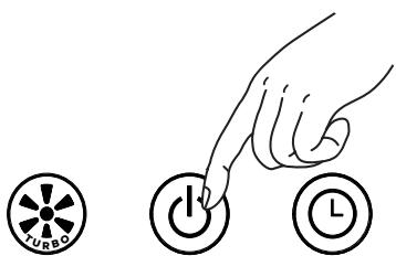
6. Держите нажатой в течение 20 секунд кнопку ВКЛ./ВЫКЛ. на включенном воздухоочистителе, пока не погаснет красная индикация ФИЛЬТР.
