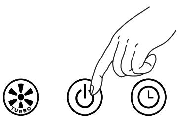
6. Mantenga pulsada la tecla de encendido y apagado del purificador de aire encendido durante 20 segundos hasta que se apague la indicación "FILTER" roja.
