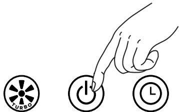
6. Halten Sie die EIN/AUS-Taste am eingeschalteten Luftfilter für 20 Sekunden gedrückt, bis die rote FILTER-Anzeige erlischt.
