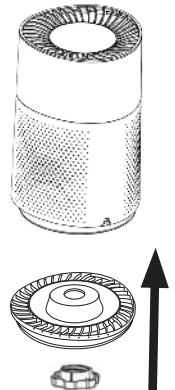
5. Установите обратно дно прибора и крепко затяните большой поворотный затвор на нижней стороне.
