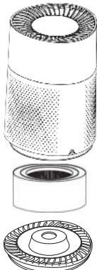
3. Der Filter und der Gehäuseboden lassen sich nun nach unten abnehmen.
