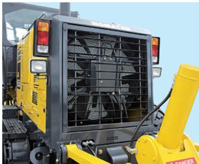
Ventilateur de refroidissement à entraînement hydraulique
