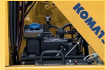
Réservoir d'AdBlue® facilement accessible
