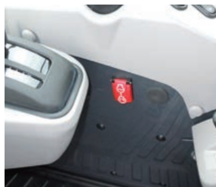
Interrupteur d'arrêt secondaire du moteur
