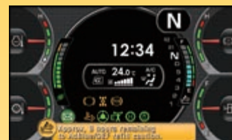
Assistance à la vérification du niveau et au remplissage du liquide AdBlue®
