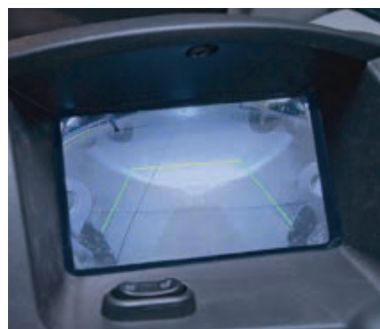
Système de caméra vue arrière
