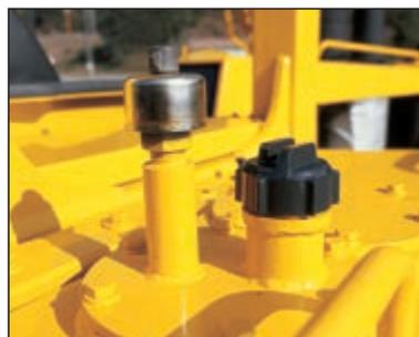
Le réservoir de carburant est doté d'un reniflard avec filtre puissant et vanne de pression pour éviter que la poussière y entre.
