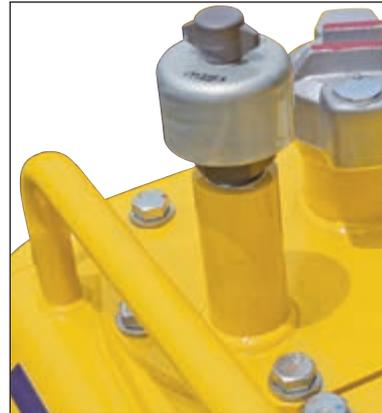
Le réservoir de carburant est doté d'un reniflard avec filtre puissant et vanne de pression pour éviter que la poussière y entre.
