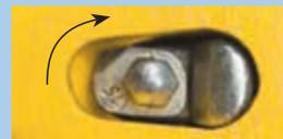
Pour verrouiller, utiliser la douille adaptée, tourner l'axe de verrouillage de 90° dans le sens des aiguilles d'une montre pour achever l'installation.
