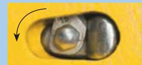
Pour enlever la fixation, utiliser la douille adaptée, tourner l'axe de verrouillage de 90° dans le sens contraire des aiguilles d'une montre.
