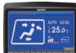
La fonction de contrôle à deux niveaux permet de garder la tête au frais et les pieds au chaud. Cette fonction permet de garder un espace de conduite agréable et confortable tout au long de l'année. La fonction de dégivrage vous assure une excellente visibilité à l'avant.
