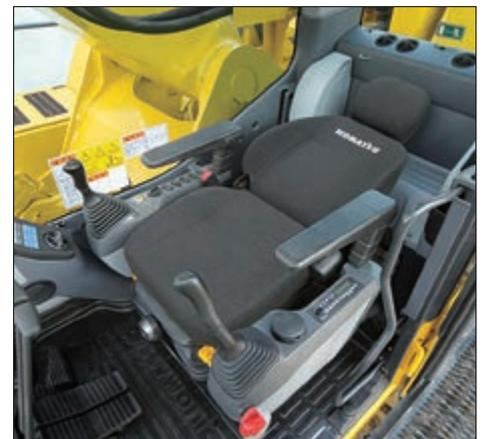
Siège avec appuie-tête inclinable à plat
