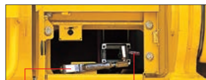
Pistolet de graissage Le pistolet de graissage est accessible au sol. Témoin
