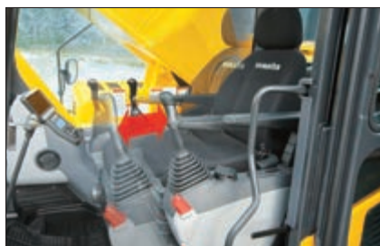
Plage de glissement du siège : 340 mm
