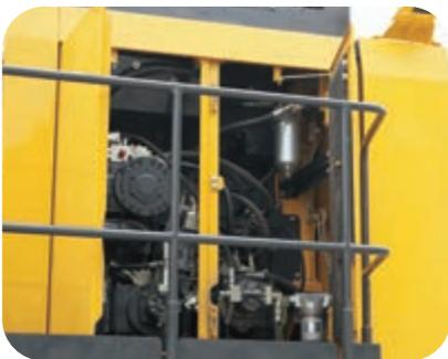
Une large passerelle éclairée offre un accès aisé aux points d'inspection et de maintenance. De plus, les points de maintenance sont regroupés pour faciliter les inspections du moteur et des composants hydrauliques.
