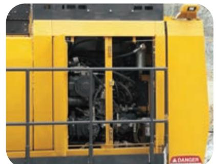
Une cloison évite les projections d'huile sur le compartiment moteur en cas de fuite d'huile.
