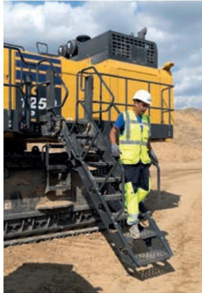
L'escalier hydraulique permet un accès et une sortie plus sûrs de la machine.
