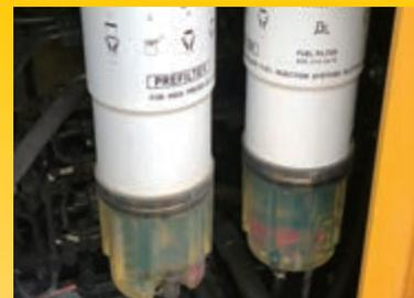
Pré-filtre à carburant grande capacité avec séparateur d'eau
