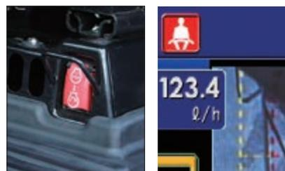
Interrupteur d'arrêt secondaire du moteur et avertissement de ceinture de sécurité
