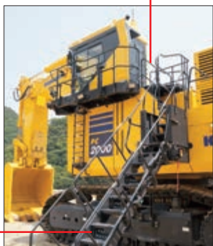
Escalier d'accès à 45°
