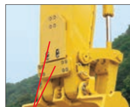
Protection du balancier contre les roches
