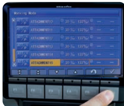
Komatsu Integrated Attachment Control (KIAC) voor tot 15 instellingen voor oliestroom en oliedruk van uitrustingsstukken (optie)
