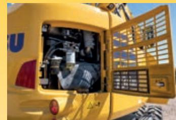
Alle belangrijke onderhoudspunten zijn goed bereikbaar vanaf de grond
