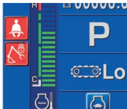
Voyants pour ceinture de sécurité et système de détection du point mort des manipulateurs
