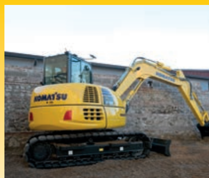
Avec la réduction du rayon de giration frontal et le déport en pied de flèche, le creusage de tranchées devient un jeu.
