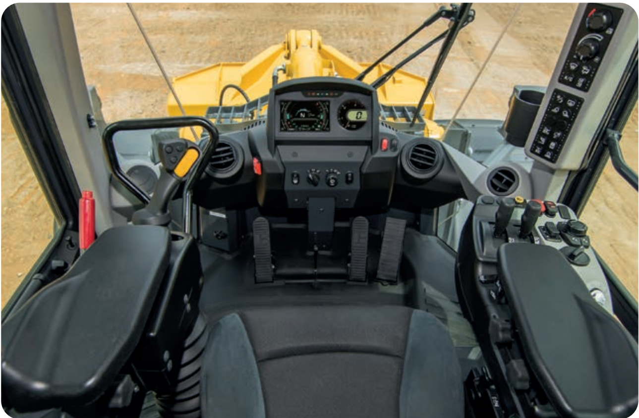
De afbeelding toont de geavanceerde joystickbesturing (AJSS) (optie)
