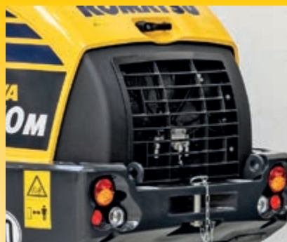
Radiateur à grandes alvéoles avec ventilateur à inversion automatique (en option)
