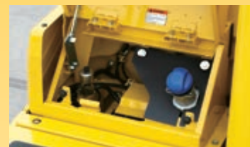
Pour faciliter l'accès au réservoir d'AdBlue®, celui-ci est installé sur l'escalier avant.
