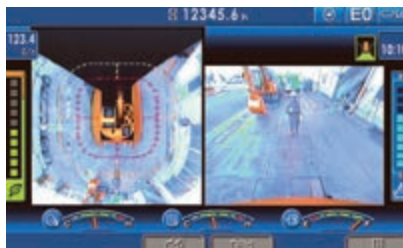
KomVision offre plusieurs vues grâce au réseau de caméras, tout en maintenant affichée en permanence une vue aérienne, depuis le dessus de la machine
