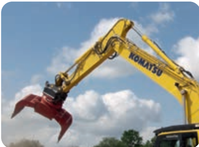
Deux circuits hydrauliques disponibles en option permettent d'utiliser une vaste gamme d'accessoires
