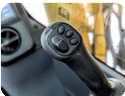
Commandes pratiques, ergonomiques et précises: leviers à bouton de commande proportionnel pour les accessoires
