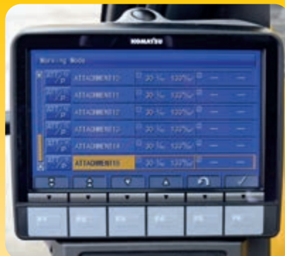
Komatsu Integrated Attachment Control (KIAC) voor tot 15 instellingen voor oliestroom en oliedruk van uitrustingsstukken (optie)
