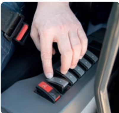
Ergonomisch ontworpen oplichtende schakelaars voor een veilige en comfortabele bediening in het donker
