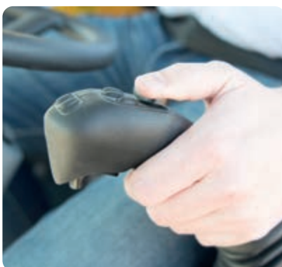
Ergonomische joysticks met proportionele controle
