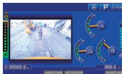
L'image de la caméra vue arrière peut être affichée
