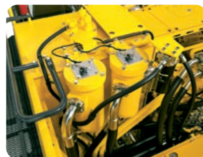
Le système de détection de saturation du filtre d'huile indique quand remplacer le filtre et évite des dégâts catastrophiques au système hydraulique.
