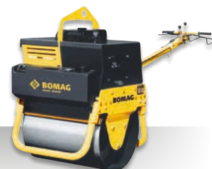
BW 71 E-2 Poids en charge : 488 kg Force centrifuge : 16 kN Largeur de travail : 710 mm
