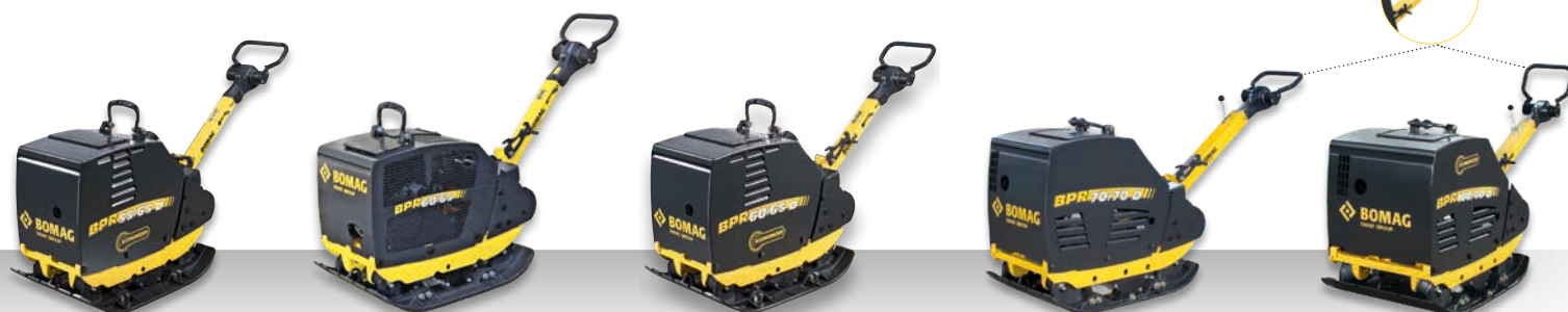
BPR 55/65 D Poids en charge : 455 kg Force centrifuge : 55 kN Largeur de travail : 650 mm BPR 60/65 Poids en charge : 400 kg Force centrifuge : 60 kN Largeur de travail : 650 mm BPR 60/65 D Poids en charge : 460 kg Force centrifuge : 60 kN Largeur de travail : 650 mm BPR 70/70 D Poids en charge : 580 kg Force centrifuge : 70 kN Largeur de travail : 700 mm BPR 100/80 D Poids en charge : 710 kg Force centrifuge : 100 kN Largeur de travail : 800 mm
