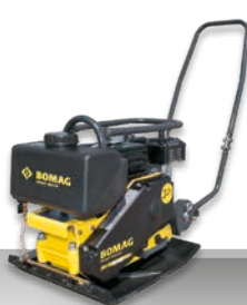
BVP 18/45 Poids en charge : 91 kg Force centrifuge : 18 kN Largeur de travail : 450 mm
